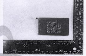
3.7V 1370mAh LI-ION BATTERY HCP404265ZC 1ICP4/43/66 5.07Wh 2019/6/19
